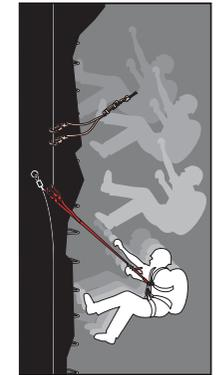
Bei einem Sturz in ein fixiertes Seil muss dieses die gesamte Energie durch Dehnung absorbieren. Wegen der Kürze des Seilstücks am Klettersteig und der grossen möglichen Sturzhöhen (hoher Sturfaktor) können dabei gewaltige Kraftspitzen (Fangstoss) auftreten – wie beim Abbremsen durch einen Betonboden. Noch härter wird die Bremsung, wenn man Reepschnur- oder Bandmaterial statisch verwendet, denn diese dehnen sich nicht und erzeugen einen noch grösseren Fangstoss. Absolute Lebensgefahr!
