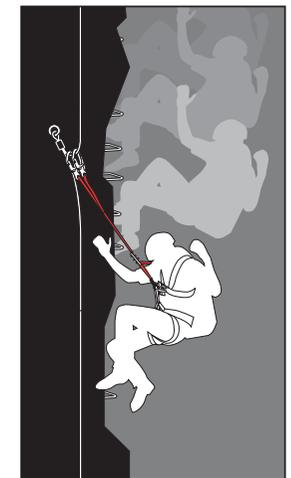
Wegen des oft gestuften Geländes und der herausstehenden Sicherungen sollte ein Sturz im Klettersteig unbedingt vermieden werden. Doch im Fall eines Falles sichert die Klettersteigbremse Überleben und Unversehrtheit, weil sie die →Sturzenergie durch Band- oder Seildurchlauf körperchonend absorbiert.
